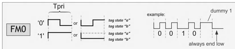
Figure 8.41 Default G2 tag signaling (FM0).
