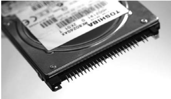
Figure 1-23: Mini IDE disk interface
