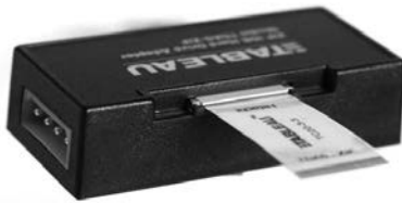
Figure 1-24: Micro IDE ZIF interface
